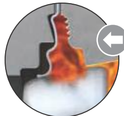
Presión de línea aplica en la dirección de flujo no preferida . (Durante o después de un incendio)
